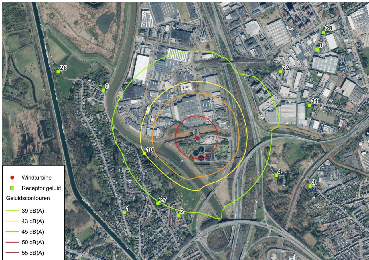
Figuur 3-8: Geluidsmodellering volgens ISO 9613-2 (2024) voor het project (WT1) in 'gereduceerde modus' (avond- en nachtperiode), bij 95% van het nominaal vermogen, uitgevoerd met het WindPRO-model
