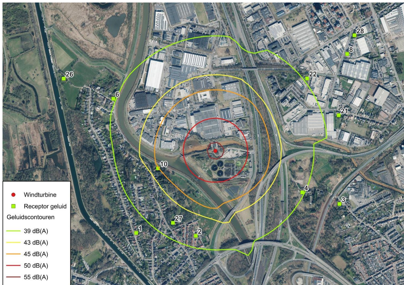
Figuur 3-6: Geluidsmodellering volgens ISO 9613-2 (2024) voor het project (WT1) in 'standaardmodus', bij 95% van het nominaal vermogen, uitgevoerd met WindPRO – nachtperiode
