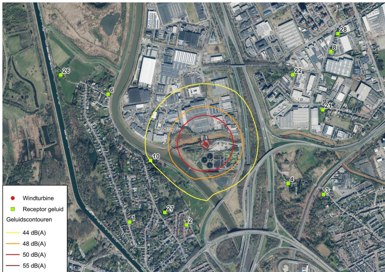
Figuur 3-3: Geluidsmodellering volgens ISO 9613-2 (1996) voor het project (WT1) in 'standaardmodus', bij 95% van het nominaal vermogen, uitgevoerd met WindPRO – dagperiode
